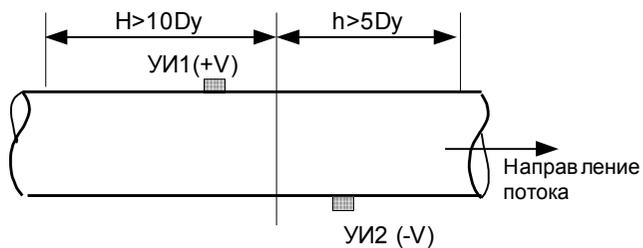
ЭСКИЗ МОНТАЖА ПП-1 ДЛЯ ИЗМЕРЕНИЯ РАСХОДА В ТРУБОПРОВОДЕ
