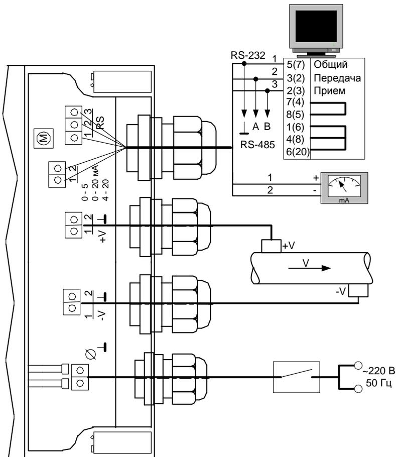
\* Указан основной вариант для подключения расходомера к 9-контактному порту, а в скобках – для подключения к 25-контактному порту компьютера.
