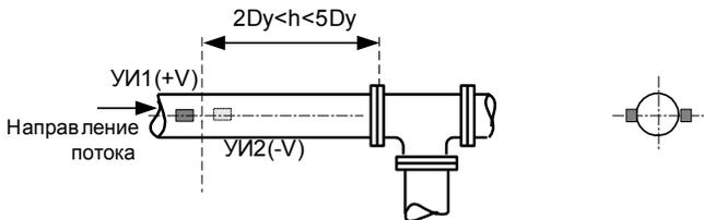
ЭСКИЗ МОНТАЖА ПП-1 ДЛЯ ИЗМЕРЕНИЯ РАСХОДА В ТРУБОПРОВОДЕ
