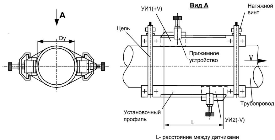
**Вариант крепления с помощью зажима**
