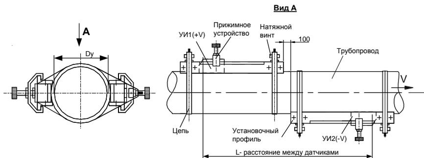
**Вариант крепления с помощью зажима**
