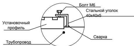
ЭСКИЗ МОНТАЖА ПП-1 ДЛЯ ИЗМЕРЕНИЯ РАСХОДА В ТРУБОПРОВОДЕ
