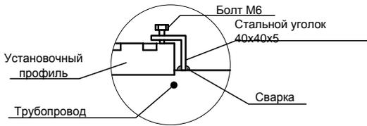
ЭСКИЗ МОНТАЖА ПП-1 ДЛЯ ИЗМЕРЕНИЯ РАСХОДА В ТРУБОПРОВОДЕ С
