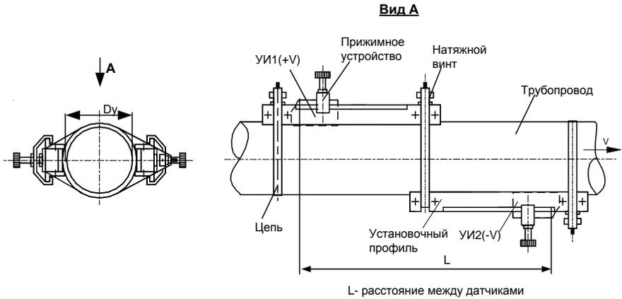
**Вариант крепления с помощью зажима**
