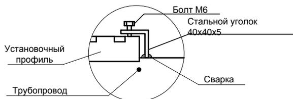
ЭСКИЗ МОНТАЖА ПП-1 ДЛЯ ИЗМЕРЕНИЯ РАСХОДА В ТРУБОПРОВОДЕ
