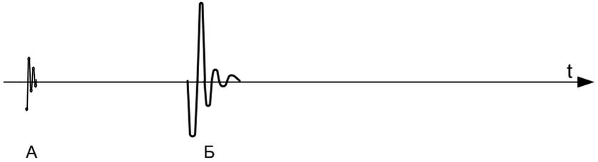
А – электрическая помеха в момент излучения зондирующего ультразвукового импульса;
