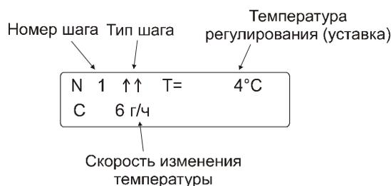
Рисунок 4 – Отображение редактора программ на дисплее прибора
