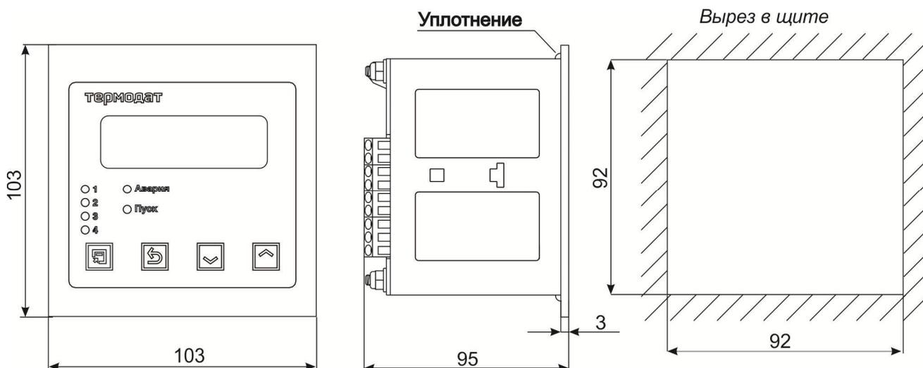
Рисунок 12 – Габаритные размеры прибора Термодат-14E5/..../IP67пп или Термодат-14E5-A7
