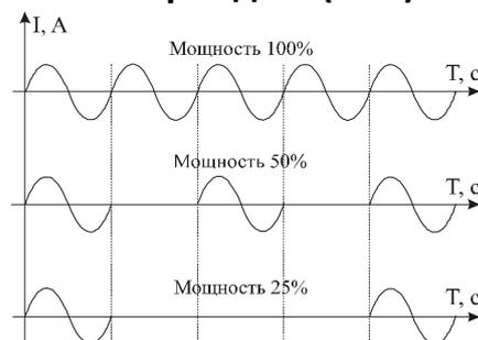
**Фазоимпульсное управление (ФИУ)** позволяет плавно изменять мощность на нагревателе. Метод реализуется только на транзисторном выходе. При этом по транзисторному выходу в цифровом виде передается требуемая мощность, а фазоимпульсное управление реализуется внешними блоками ФИУ или МБТ. Тиристоры открываются с регулируемой фазовой задержкой от 0 до 180° каждый сетевой полупериод. Метод хорошо
