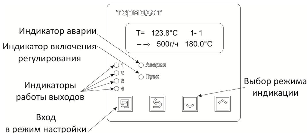
Рисунок 2 – Описание индикаторов и кнопок управления прибора
