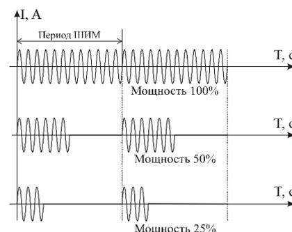
При методе **равномерно распределенных рабочих сетевых периодов (РСП)** ток через нагреватель периодически включается на один или несколько сетевых периодов. Мощность нагревателя испытывает меньшие колебания во времени, чем при использовании ШИМ. Этот метод очень хорош в лабораторных условиях при малых мощностях нагревателя. Не используйте метод при мощностях более 5 кВт. Недопустимо использование метода РСП при индуктивной нагрузке.
