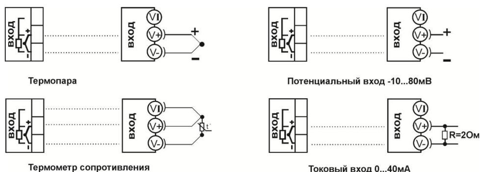
Рисунок 5 – Схемы подключения датчиков
