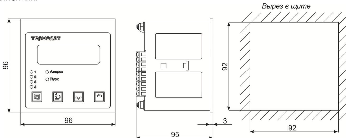
Рисунок 11 – Габаритные размеры прибора 14E5/..../ или Термодат-14E5-A
