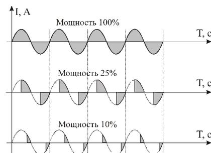
использовать для работы с нагревателями с малой тепловой инерцией. Фазоимпульсное управление часто используют для работы с понижающими трансформаторами с низкоомной нагрузкой во вторичной обмотке.
